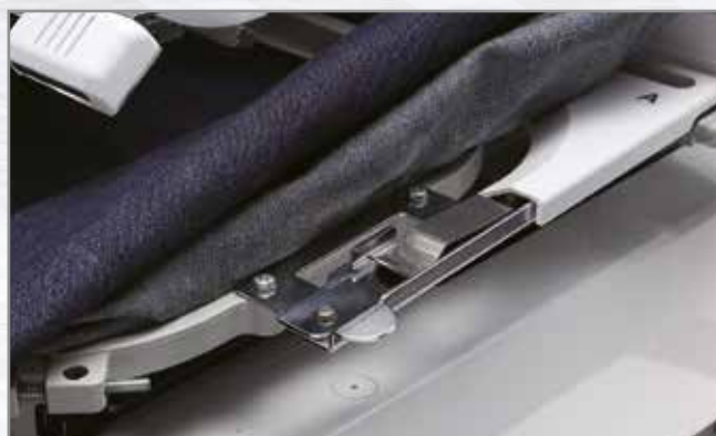
Les pièces de tissu volumineuses peuvent recouvrir la partie supérieure du bras
