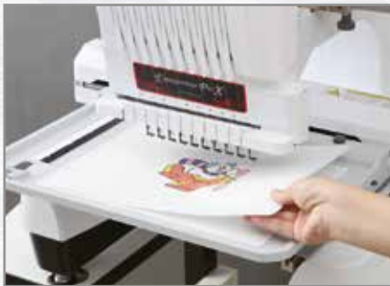
Positionnez l'image imprimée sur le cadre de numérisation
