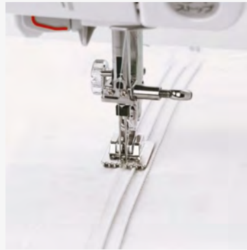
Pied pour nervures étroites avec aiguille jumelée (N2)
