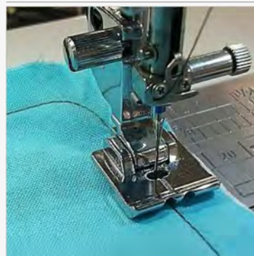
Pied pour passepoil (étroit) - Largeur max. de la mèche 3 mm
